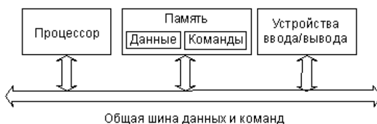
Рис. 17. Архитектура с общей шиной данных и команд.
