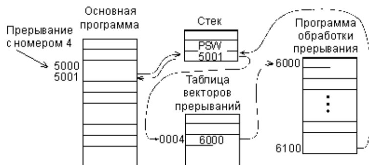
Рис. 37. Упрощенный алгоритм обработки прерывания.
