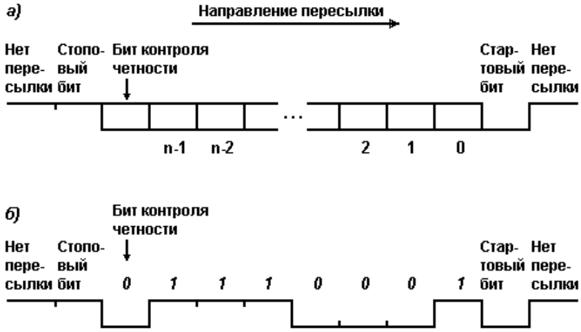
Рис. 53. Формат асинхронной последовательной передачи данных.
