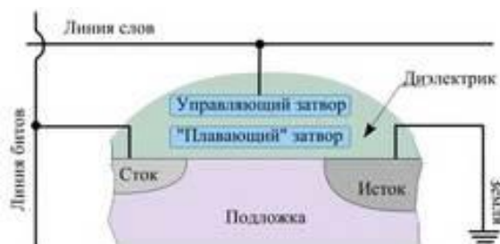
Рис. 66. Ячейка флэш-памяти на одном транзисторе.
