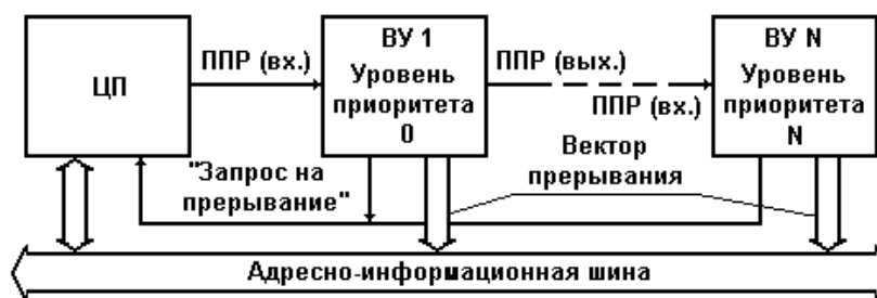
Рис. 48. Реализация приоритетов ВУ в МПС с векторной системой прерываний: с интерфейсным вектором ППР (вх) - "Предоставление прерывания (входной)"; ППР (вых) – "Предоставление прерывания (выходной)"
